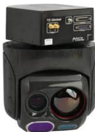
Rysunek 2.20 Głowica typu TASE model 300.
